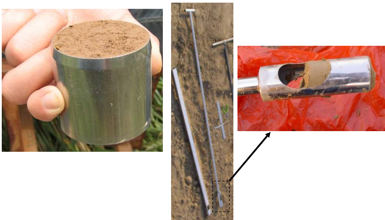
图 2.8 测定容重装置：环刀和土钻
